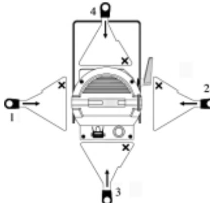
Schieben Sie die Blendenschieber entsprechend der Beschreibung ein und mit den Ecken, die mit «X» gekennzeichnet sind, zuerst.
